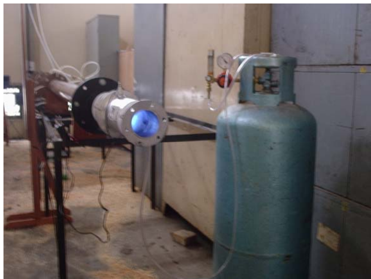
Fig. 5.9 - Câmara operando na bancada
