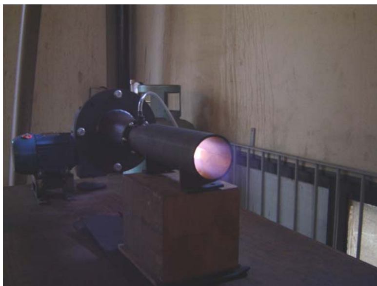
Fig. 5.3 – Foto da pré-câmara operando
