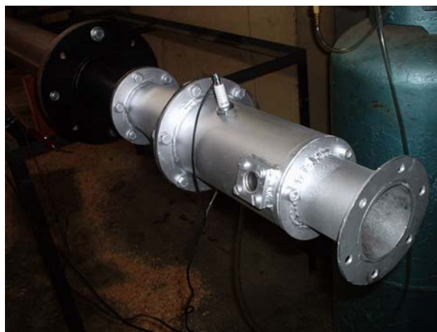
Fig. 5.12 - Câmara de Combustão montada
