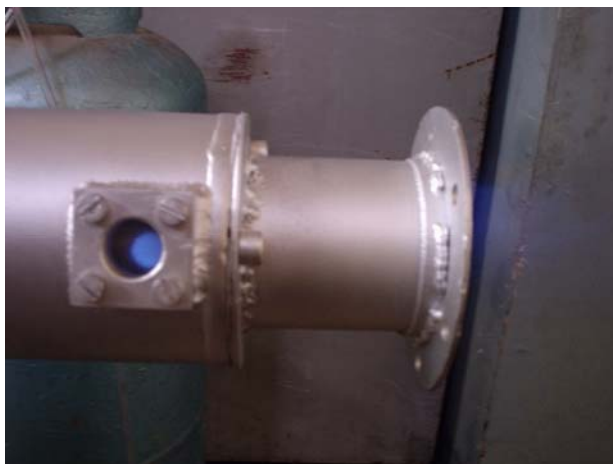
Fig. 5.14 - Câmara de Combustão operando
