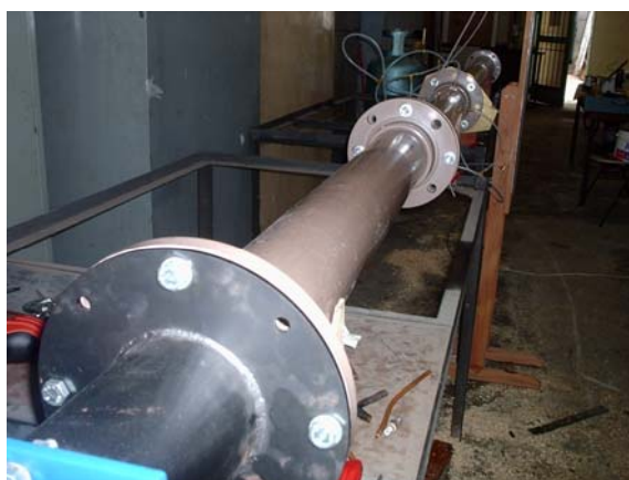
Fig. 5.6 - Foto do medidor de vazão
